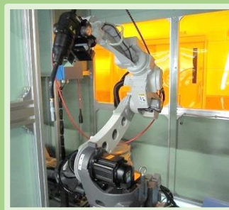
▲溶接ロボット
