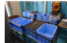
黒クロムニッケルめっき試験設備
